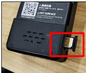
② nano SIMトレイをスロットに挿入します。
