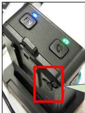
DC挿入口カバーの下部が浮きがない状態が正しくしまっている状態です。
